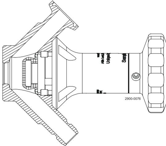
手动阀：以逆时针方向旋转手柄，打开阀门。气动阀：激活执行机构，打开阀门。此时可缩回阀杆和薄膜密封件，从而允许产品自由流过打开的阀门。
