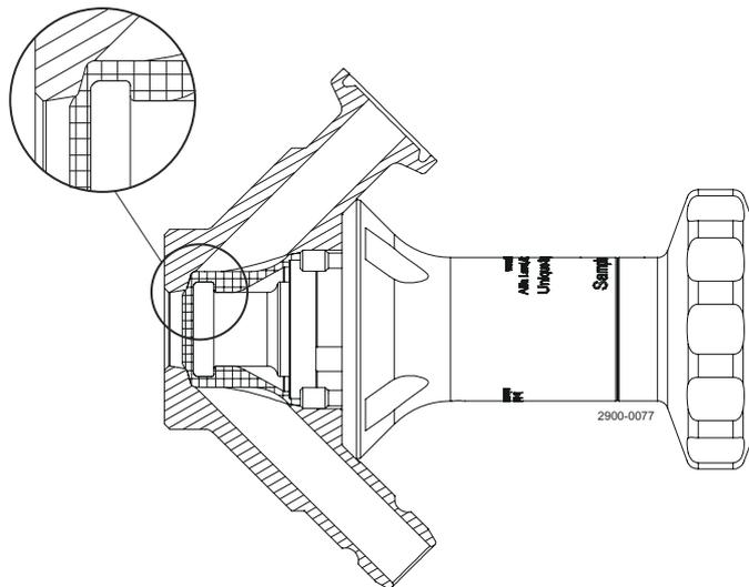
手动阀：以顺时针方向旋转手柄，关闭阀门。气动阀：关闭气源口，防止产品从阀中流出。关闭阀后，可对阀体进行消毒。如果使用蒸汽进行就位灭菌，建议在出口处使用泄压阀选件，以确保阀内蒸汽温度合适。
