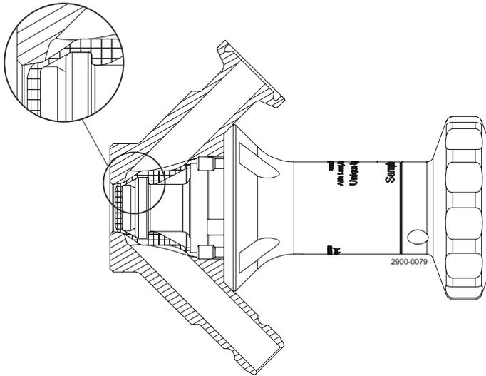
手动阀：顺时针旋转手柄到蒸汽位置。气动阀：向蒸汽接口供入空气。这样可以将阀头的内阀杆伸入内阀座，阻止产品在阀口的流动。同时，阀的外阀杆缩回，将薄膜密封件从其正常阀座上拉起。此时，可以进入阀座表面难以触及的区域，确保灭菌彻底。这使得独特的取样阀（双阀座）成为了实现 100%精准取样的可靠之选。
