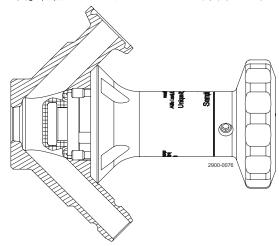
手動バルブ: ハンドルを反時計回りに回転させ、バルブを開きます。空気式バルブ: アクチュエータを作動させてバルブを開きます。これにより、バルブステムと膜シールが格納され、製品が開バルブを通じて自由に流れるようになります。
