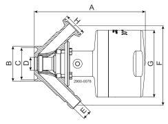
図 1. バルブボディのハンドル:カラー付きチューブの溶接 図 2. バルブボディの空気式:カラー付きチューブの溶接
