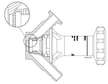
手動バルブ: ハンドルを時計回りに回転させ、バルブを閉じます。空気式バルブ: 空気の供給を止めて、バルブからの製品の流れを止めます。閉じたポジションのバルブボディは、これで滅菌の準備が整いました。定置滅菌に蒸気を使用する場合は、バルブ内の蒸気温度を適切に保つために、オプションの圧力リリーフバルブを出口に使用することをお勧めします。
