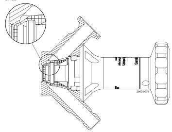
手動バルブ: ハンドルを蒸気位置へと時計回りに回転させます。空気式バルブ: 蒸気接続に空気を供給します。これにより、バルブヘッドの内部スピンドルが内部シートまで伸び、バルブポートでの製品の流れを停止します。同時に、バルブヘッドの外側スピンドルが格納され、膜シールが標準シートから持ち上げられます。この後は、シート表面の手が届きにくい部位に到達しやすくなり、完全な殺菌消毒が確実化され、これによりUnique 試料採取弁(ダブルシート)は、100%代表的なサンプリングを実現するために、確実かつ信頼出来る選択肢となります。
