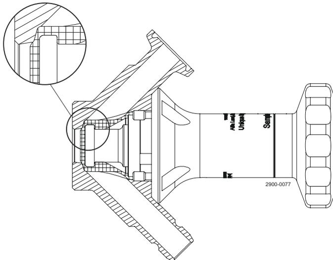
Vanne manuelle : tournez la poignée dans le sens horaire pour fermer la vanne. Vanne pneumatique : fermez l'alimentation en air pour arrêter l'écoulement du produit hors de la vanne. En position fermée, le corps de vanne est maintenant prêt pour la stérilisation. Si la vapeur est utilisée pour la Stérilisation en Place, il est recommandé d'utiliser une soupape de décharge optionnelle sur la sortie afin de garantir une température de vapeur adéquate dans la vanne.
