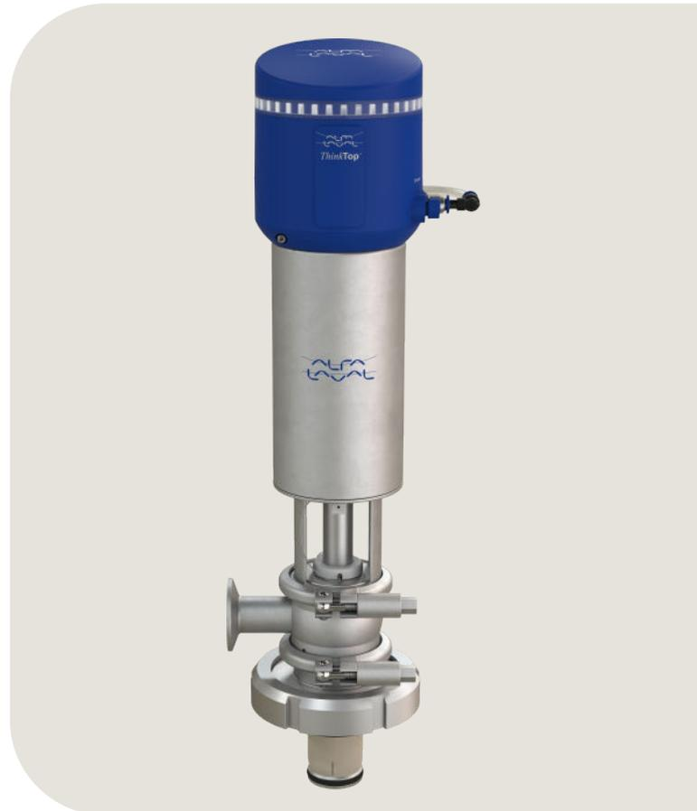
und modular entwickelte Free Rotating Retractor UltraPure aus Edelstahl AISI 316L für produktbenetzte Metallteile. Prozessbenetzte Teile weisen eine Oberflächengüte von Ra 0.8 auf. Produktbenetzte Teile sind elektropoliert, mit einer Oberflächengüte von Ra 0.38. Produktbenetzte Elastomere und Polymere sind lebensmittelkonform (FDA- und EU-Vorschriften) und erfüllen die pharmazeutischen Normen (USP 87 and 88 Class VI or ISO 10993-5 und ISO 10993-6, -10, -11).
