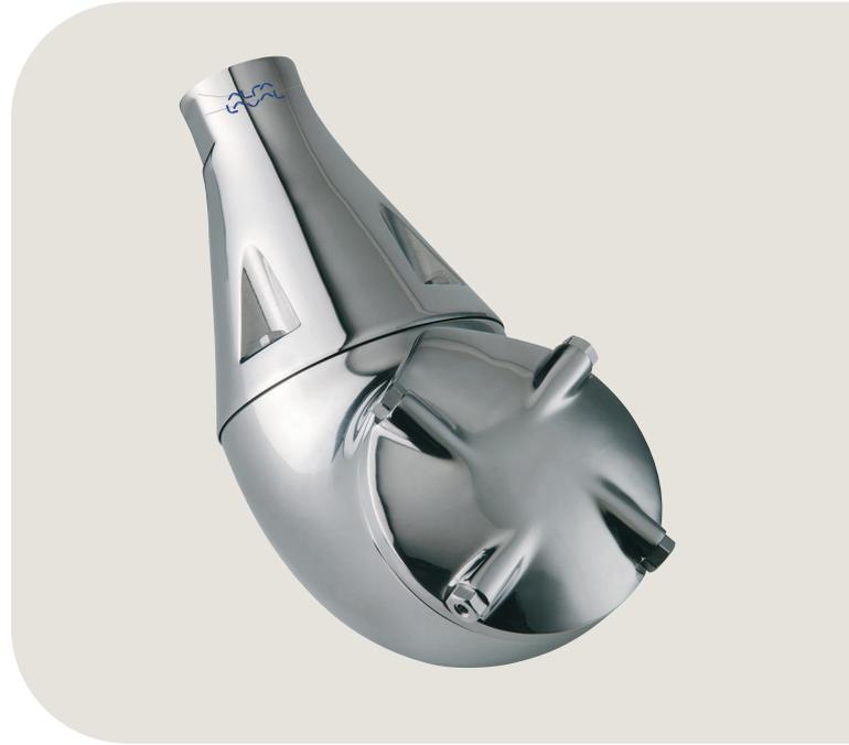
置し、液体に浸されていることを確認してください。4本のノズルから、タンク内の液体、気体、粉体を送り込む。ノズルは水平軸と垂直軸の両方を中心に 360° 回転します。この3次元的なジェット回転により、ジェットがタンクの全体積に到達し、バッチ回転を必要とせずに、注入された液体、気体、粉体の高速で効率的な混合を実現します。
