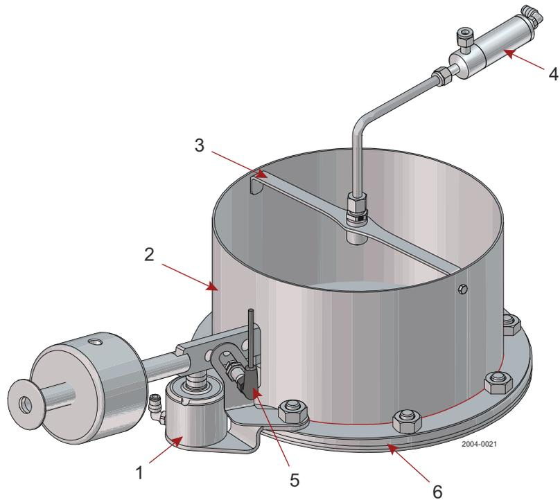
Pos. 1 : Système d'ouverture forcée : ouverture pendant le nettoyage du siège de vanne
