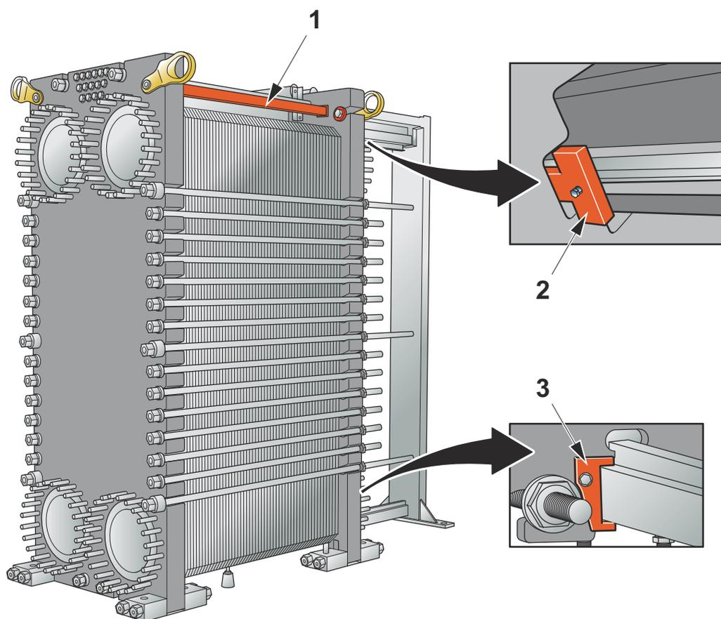
1. Надежно закрепите устройство блокировки между подвижной и неподвижной прижимными плитами.
