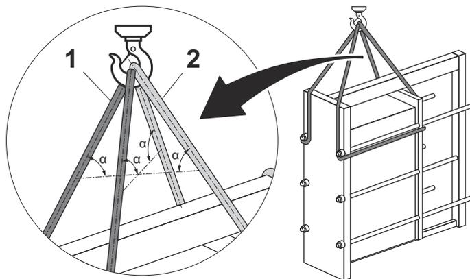
**Рис. 2: На рисунке показана обвязка стропами оборудования (пример).**
