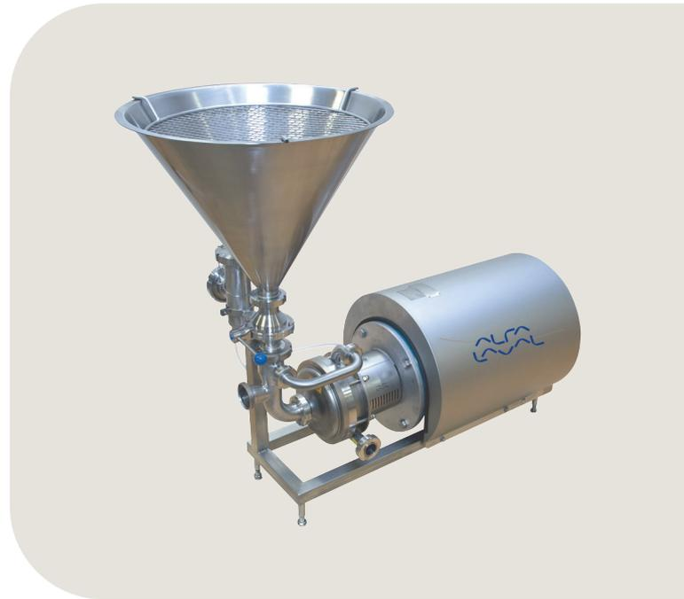
来，喷射器中的液流就会在漏斗出口处产生欠压，使得粉体能够动态地吸进液体中。
