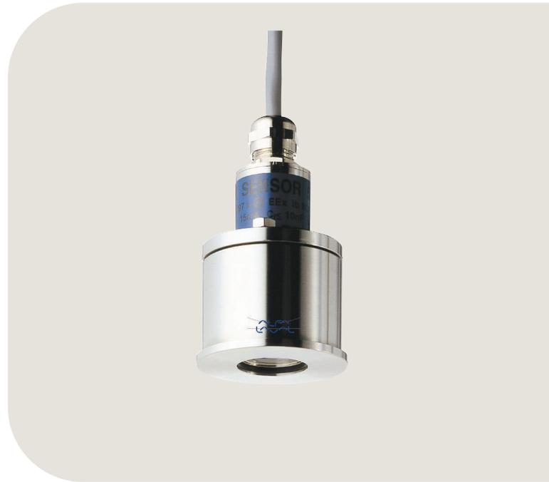
Basándose en el funcionamiento engranado del dispositivo de limpieza y en las señales que registran la fuerza de impacto de los chorros, el sensor verifica el funcionamiento higiénico de los cabezales de inyección giratorios, teniendo en cuenta cualquier contrapresión en los depósitos.
