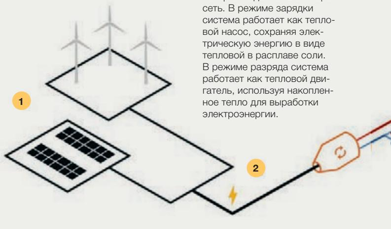
Система аккумулирования энергии Malta принимает электроэнергию, преобразует и сохраняет ее в виде тепла, а затем преобразует его обратно в электричество, которое подается в электросеть. В режиме зарядки система работает как тепловой насос, сохраняя электрическую энергию в виде тепловой в расплаве соли. В режиме разряда система работает как тепловой двигатель, используя накопленное тепло для выработки электроэнергии.
