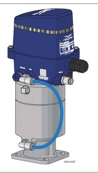
2 Verifique se o bujão de descarga de ar aponta para baixo, como indicado pela seta, para evitar a entrada de água no sistema pneumático. Pode rodar o bujão de descarga até que este aponte na direção correta.
