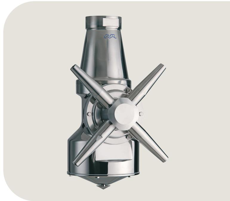
置し、液体に浸されていることを確認してください。2本または4本のノズルから、タンク内の液体、気体、粉体を送り込む。ノズルは水平軸と垂直軸の両方を中心に 360° 回転します。この3次元的なジェット回転により、ジェットがタンクの全体積に到達し、バッチ回転を必要とせずに、注入された液体、気体、粉体の高速で効率的な混合を実現します。
