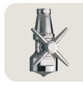
en quatre modèles différents (IM 10, IM 15, IM 20, IM 25), ces mélangeurs sont conçus pour des réservoirs de 100 litres et plus, et sont capables de gérer des débits de recirculation allant jusqu'à 90 m<sup>3</sup>/h.
