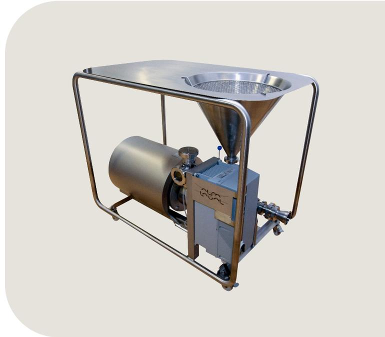
タンクに液体成分を入れた後、ハイブリッド粉体ミキサーはタンクの上で液体を循環させます。容積が 1~2m<sup>3</sup>以上のタンクでさらに高効率の混合を行うには、アルファ・ラバルのロータリー・ジェット・ミキサーの設置を強くお勧めします。
