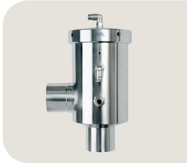
pression de consigne est réduite à la pression requise soit à l'aide d'un régulateur de précision manuel, soit d'un convertisseur IP commandé par un automate programmable industriel API. Lorsque la pression dans la cuve excède la pression de consigne, la vanne s'ouvre et libère la pression par la branche côté vanne pour évacuation atmosphérique ou collecte. Afin de garantir les conditions de fonctionnement appropriées, il ne doit pas y avoir de remontée de pression après l'évent.
