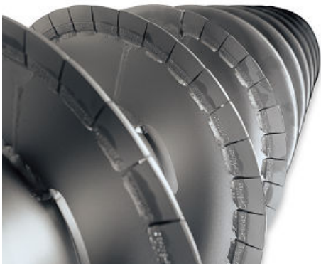
Figura 5. Plaquetas de carburo de tungsteno sinterizado como protección antidesgaste para los álabes del tornillo transportador
