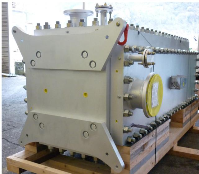
Si le Compabloc doit être installé en position horizontale, le manutentionner comme indiqué ci-dessous, en utilisant un palonnier. La manutention se fait dans ce cas avec 4 manilles de levage en tout installées sur les fonds massifs (2 manilles de levage par fond).
