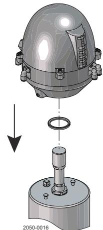
3 a) 按下 ThinkTop Basic Intrinsically Safe 顶部，确保正确安装该装置。
