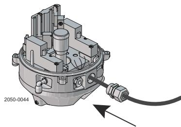
7 请确保将电缆密封套完全拧紧至 3Nm。
