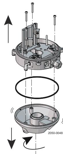
5 请拧下三颗螺钉并拉出框架，以拆除传感器框架。
