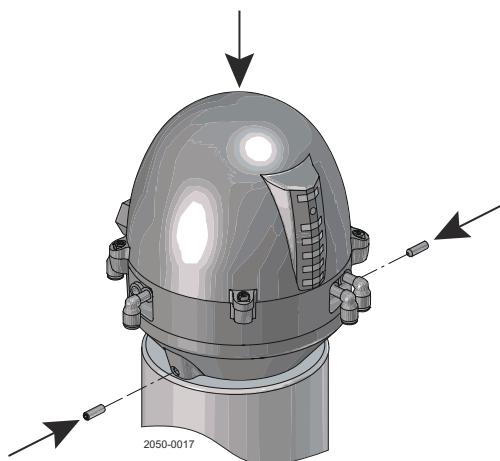
4 参照第 10 页上的空气连接图来安装空气管。
