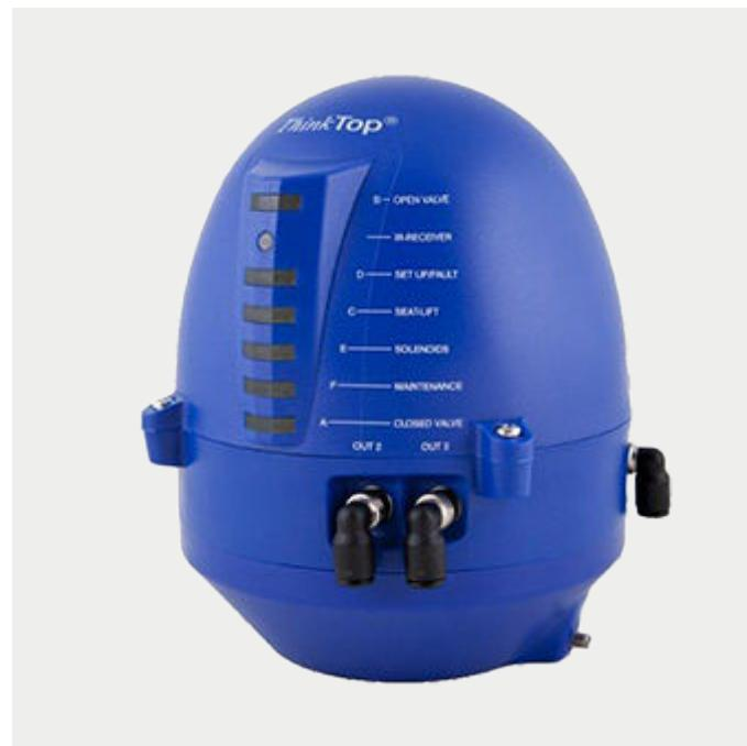
calculent l'angle avec le champ magnétique axial produit par un axe d'indication monté sur la tige de vanne.
